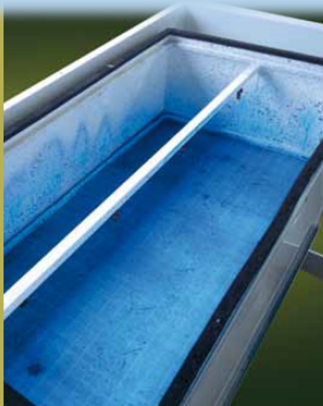
Filtro dopo il trattamento di incapsulamento
